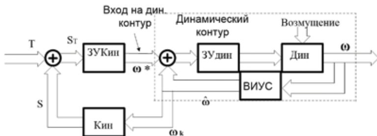
Рис. 1 – Динамический и кинематический контур СУОС МКА: Дин – динамические уравнения Эйлера; Кин – кинематические уравнения; ЗУдин – закон управления для динамического контура; ЗУкин – закон управления для кинематического контура
