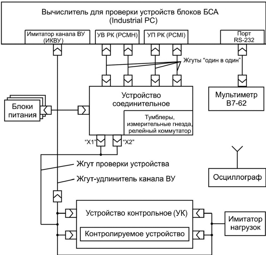
Рис. 9.3. Структурная схема автоматизированных рабочих мест для проверки блоков силовой автоматики
