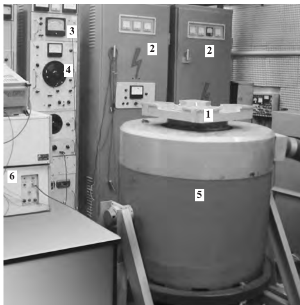
Рис. 8.1. Вибрационный стенд ВЭДС-1500
