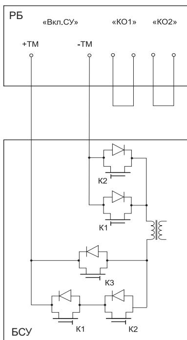
**Рис. 9.1** Схема электрического взаимодействия БСУ и РБ
