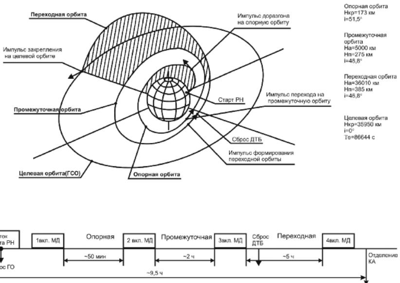
**Рис. 1.2** Схема выведения и циклограмма включения маршевого двигателя при выведении на геостационарную орбиту
