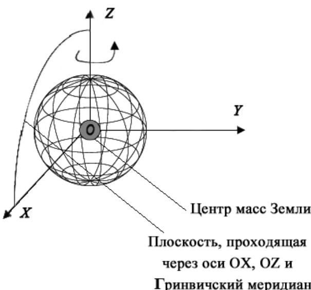
Рис. П.2. Геоцентрическая гринвичская система координат
