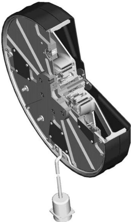
Рис. 4.4 Общий вид двигателя-маховика
