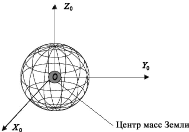
**Рис. П.1.** Геоцентрическая инерциальная система координат
