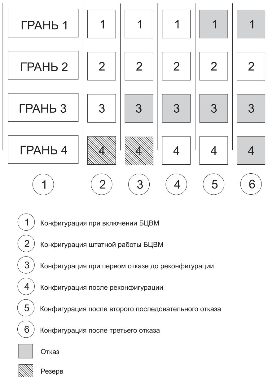
Рис. 1.10 Унифицированная структура реконфигурации
