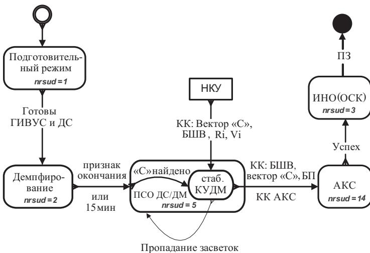
Рис. 6.6 Циклограмма функционирования СУД.
