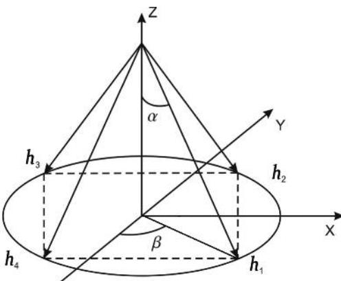
**Рис. 7.2** Схема пространственной ориентации осей вращения УДМ
