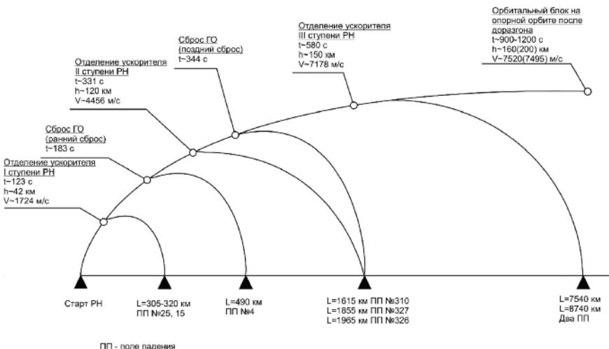
Рис. 1.1 Типовая схема полета при выводении ОБ на опорную орбиту
