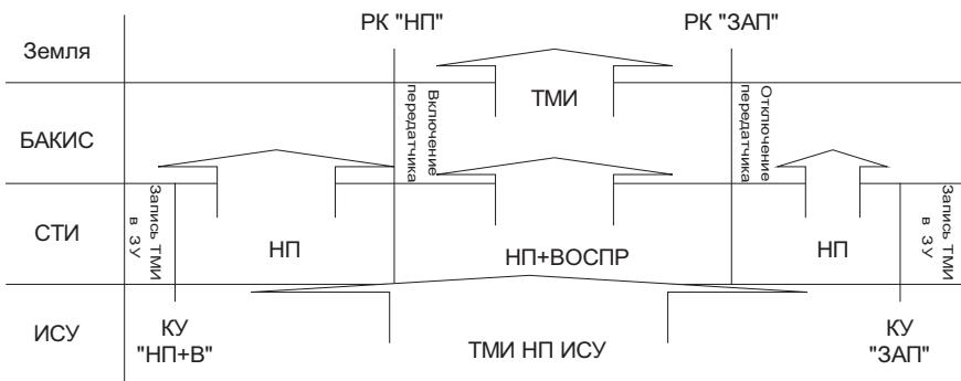
**Рис. 10.2** Штатная циклограмма работы тракта во время сеанса связи
