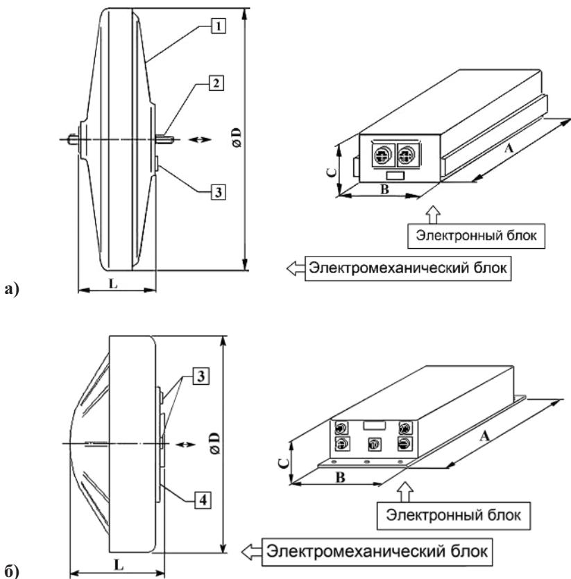
Рис. 4.6 Комплект блоков двигателей-маховиков
