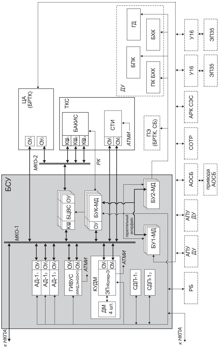
Рис. 1.6 Структурная схема БСУ КА «Экспресс-МД1»
