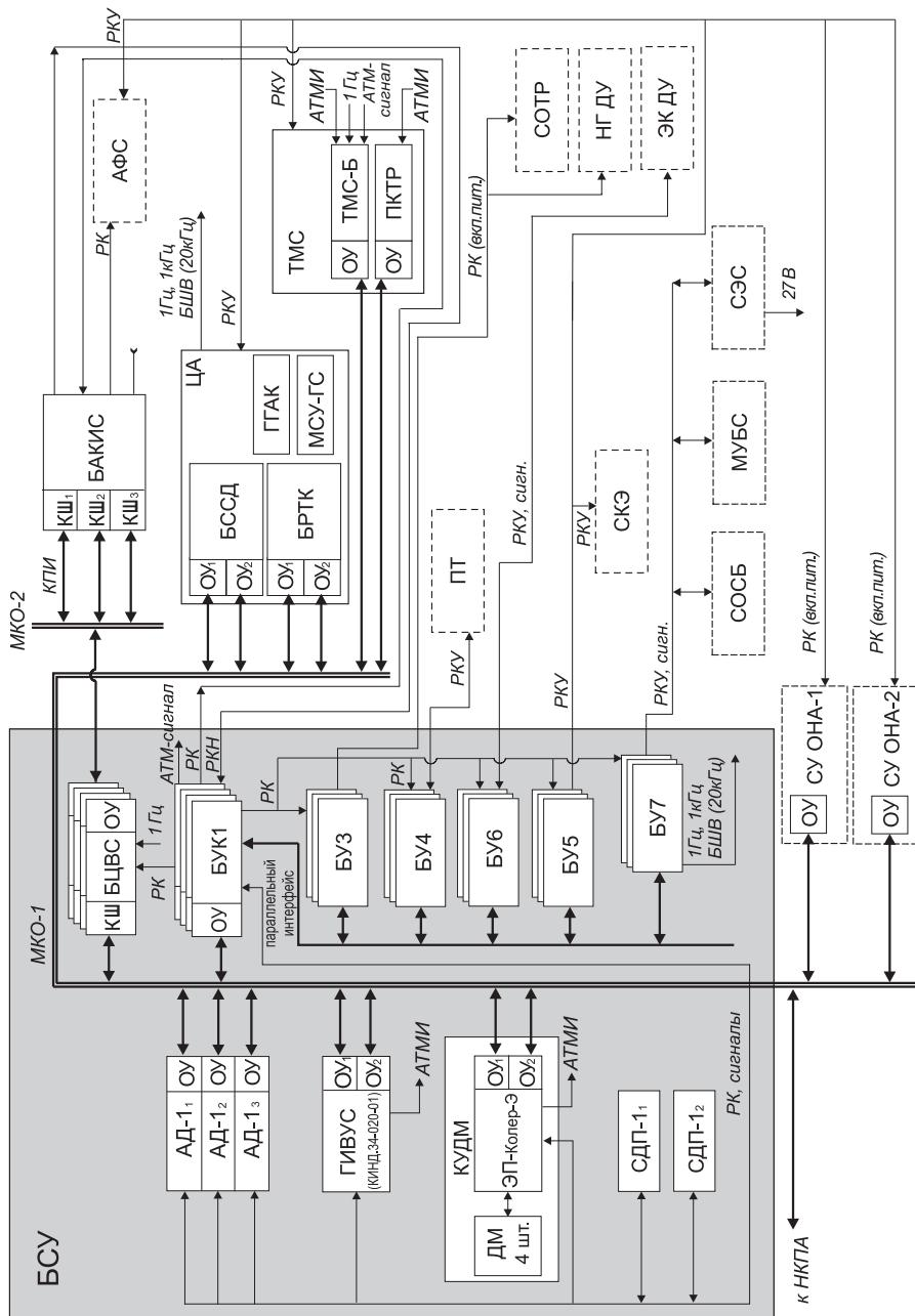
**Рис. 1.7** Структурная схема БСУ КА «Электро-Л»
