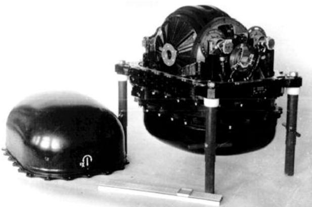
**Рис. 4.1** Двухстепенный управляющий силовой гироскоп
