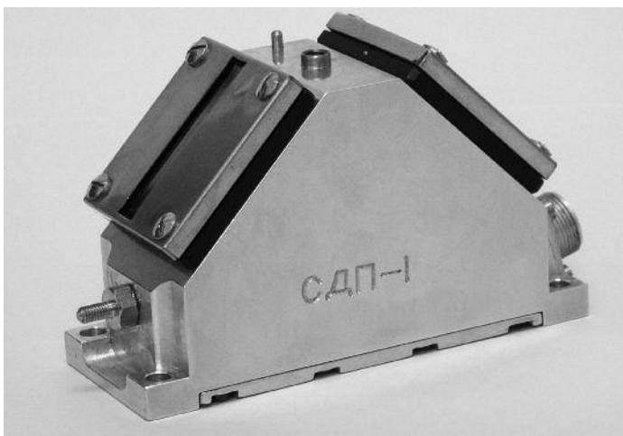
Рис. 3.7 Солнечный датчик положения разработки МОКБ «Марс»
