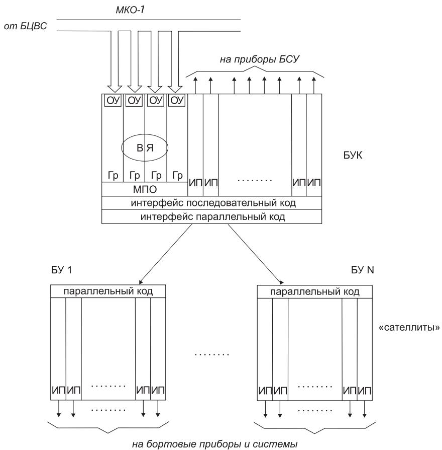
**Рис. 1.11** Принцип построения и архитектура блоков силовой автоматики
