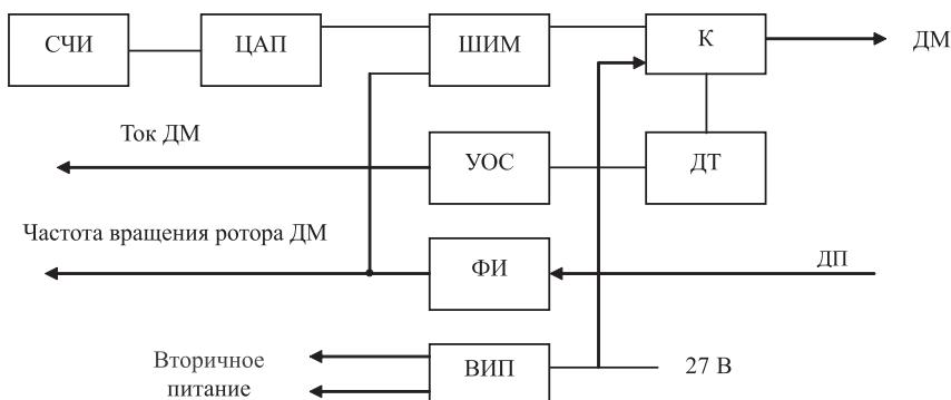
Рис. 4.5 Функциональная схема БУД
