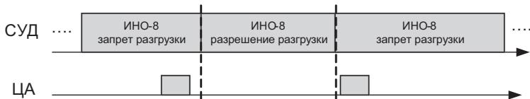
Рис. 6.9 Фрагмент ПЗ с выполнением разгрузки
