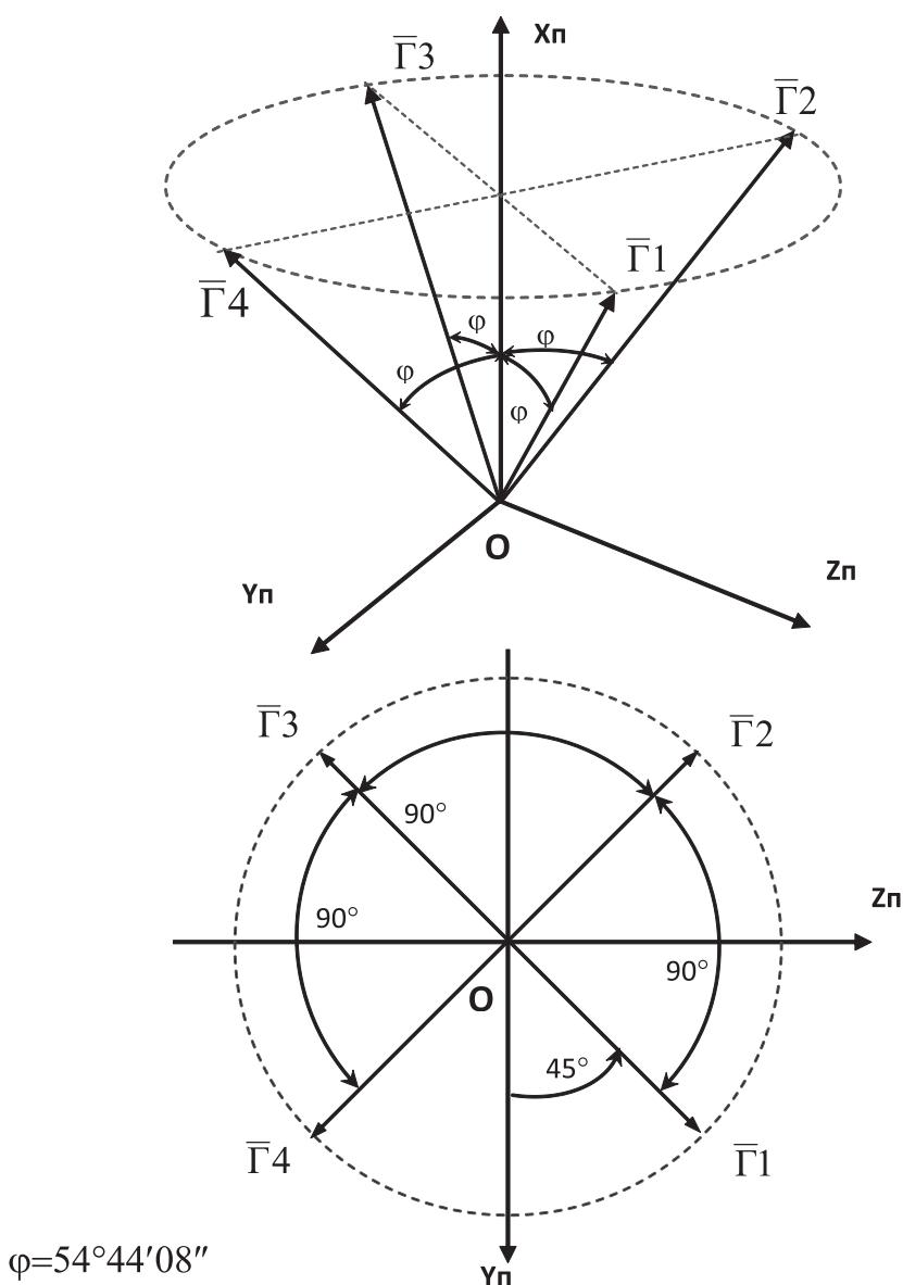
**Рис. 8.1** Расположение осей чувствительности гироблоков относительно приборной системы координат
