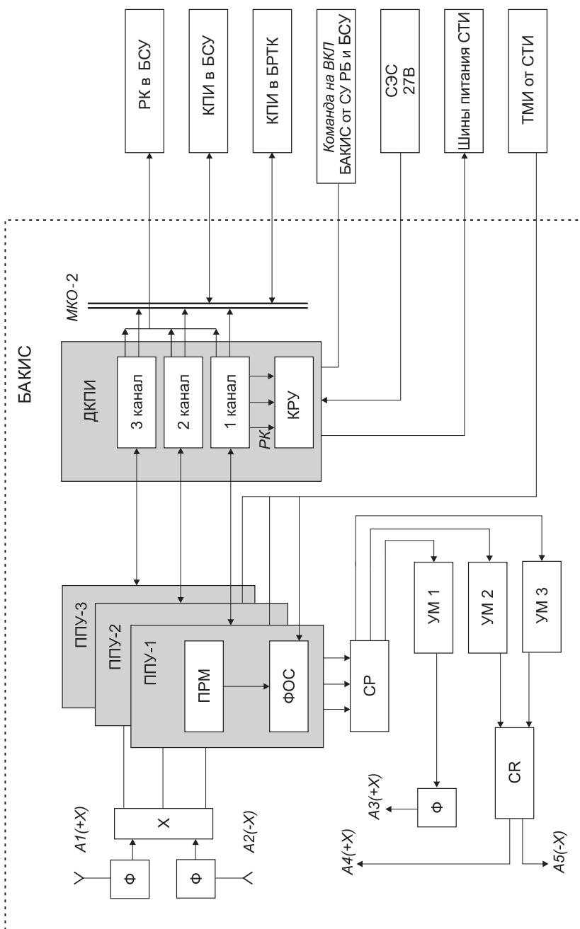
Рис. 2.1 Структурная схема БАКИС
