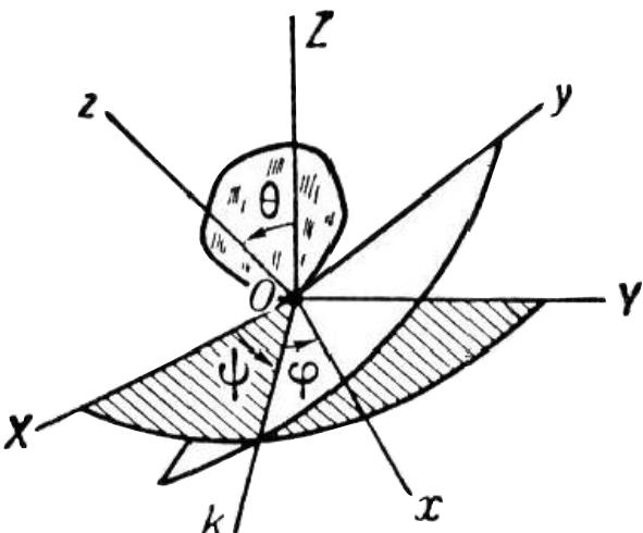
Рис. П.4. К определению углов Эйлера
