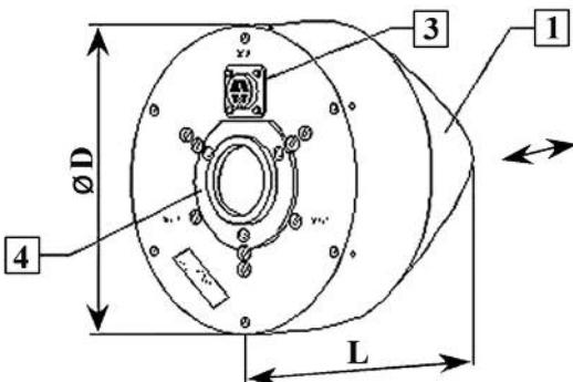
Рис. 4.7 Двигатель-маховик для КА малой массы
