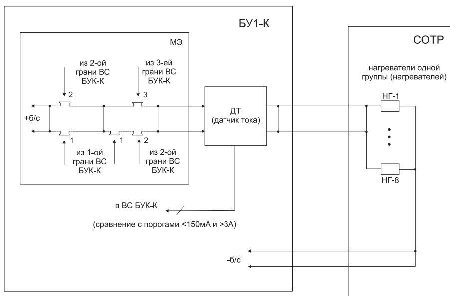
**Рис. 9.5** Функциональная схема подключения нагревателей одной группы к блоку силовой автоматики
