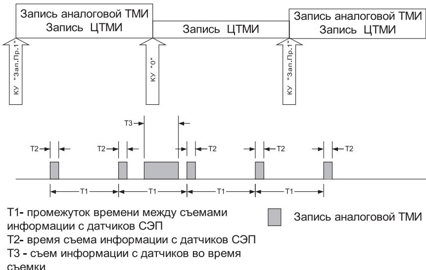
**Рис. 10.3** Циклограмма работы тракта вне сеанса связи
