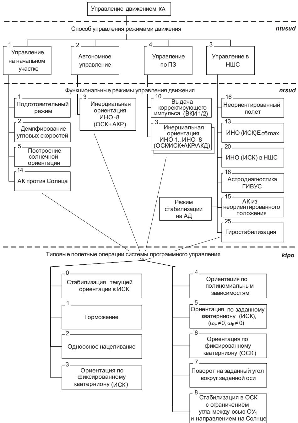
Рис. 6.4 Структура СУД КА. Управление ориентацией КА
