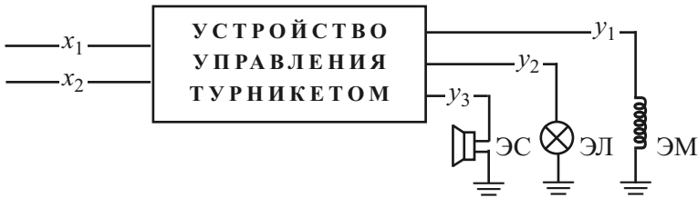
Рис. 7.5. Структура системы управления турникетом
