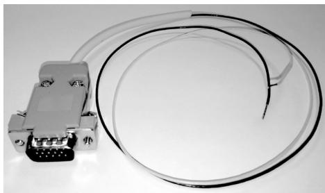
Рис. 12. Жгут для подключения
